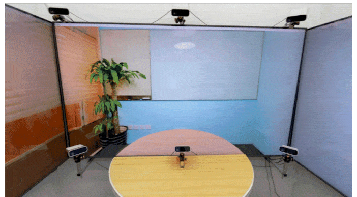
6 个 Azure Kinect RGBD 摄像头捕捉人像和眼神等动作
